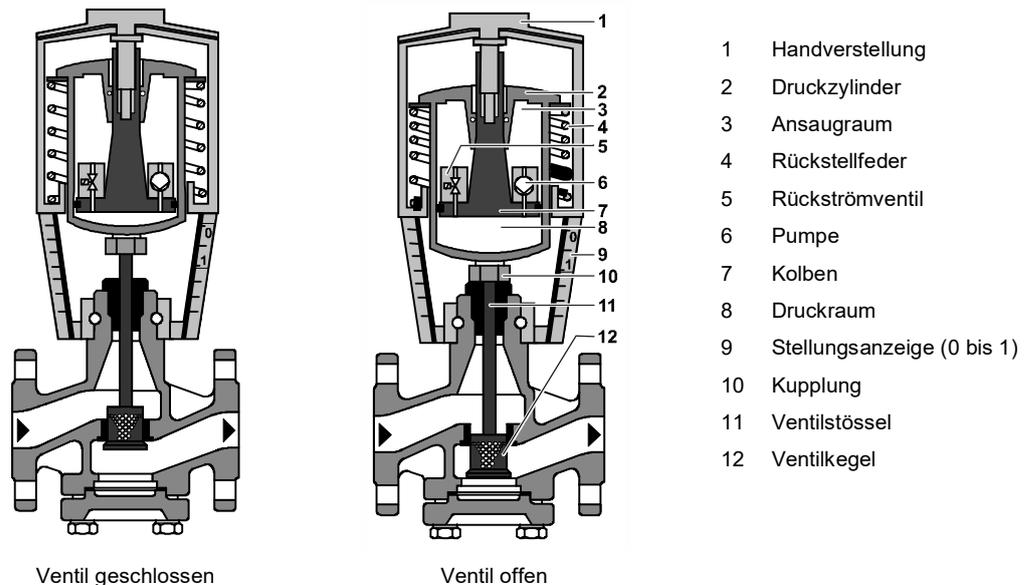
**Ventil öffnen** Die Pumpe [6] fördert Hydrauliköl vom Ansaugraum [3] in den Druckraum [8]. Der Druckzylinder [2] bewegt sich dadurch nach unten, der Ventilstößel [11] fährt ein und das Ventil öffnet. Gleichzeitig wird die Rückstellfeder [4] zusammengedrückt.
